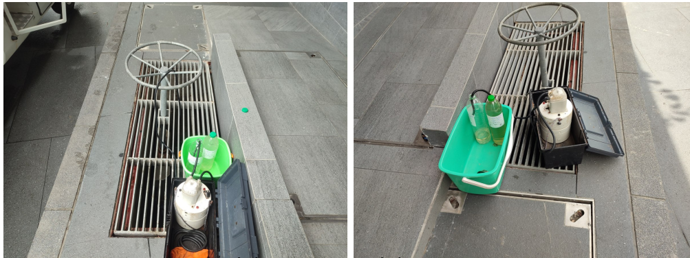
การเก็บตัวอย่างน้ำทิ้งที่บ่อตรวจคุณภาพน้ำทิ้ง ด้วยวิธี Sampling Pump
